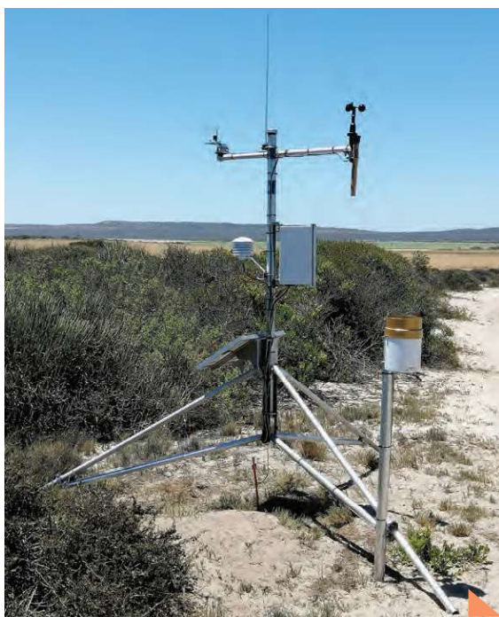
Automatiese weerstasies meet gewoonlik veranderlikes soos temperatuur, windspoed, straling, humiditeit en reënval, maar kan ook die atmosferiese verdampingsaanvraag (ETo) bereken. (Foto: Martin Steyn)
