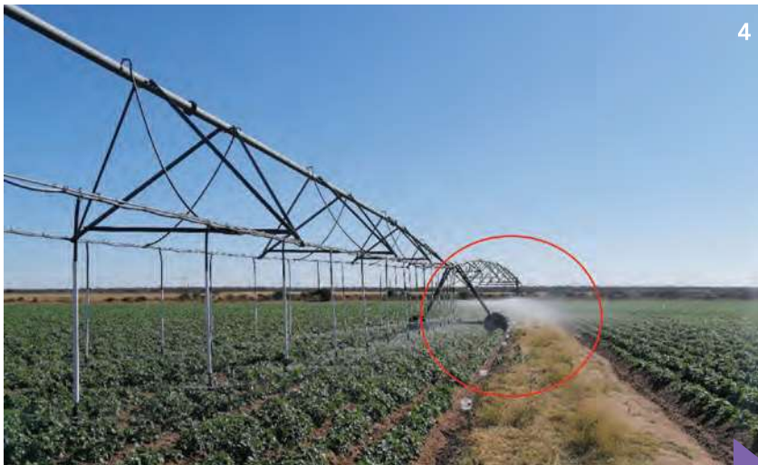
Opbreek van druppels in fyn mis onder die eerste span van LEPA-spijpunt L1, lei tot hoër verdampingsverliese.
