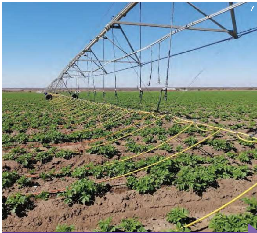
Die Dragon-Line-stelsels het lae kapasiteit gehad, wat nie aan plante se behoeftes tydens piekseisoen kon voldoen nie.
