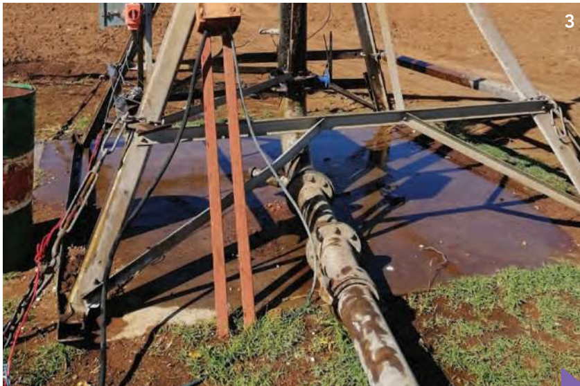
Lekkasje by die spil van stelsel L12 het tot laer toedieningsdoeltreffendheid bygedra.
