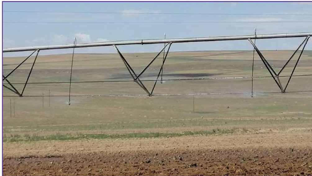
Figuur 9: Variërende lengtes van hangpype by OVS_02, wat toedieningsuniformiteit sal beïnvloed.
