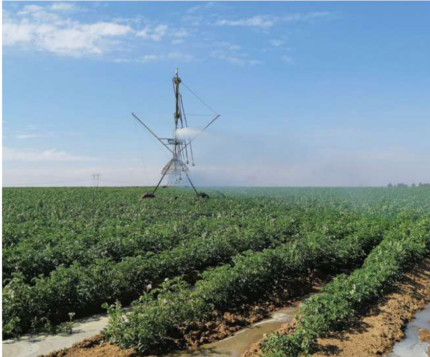
Figuur 5: Afloop onder spilpunt OVS_07 se endspuit as gevolg van hoë toedieningstempo en die helling van die land.
