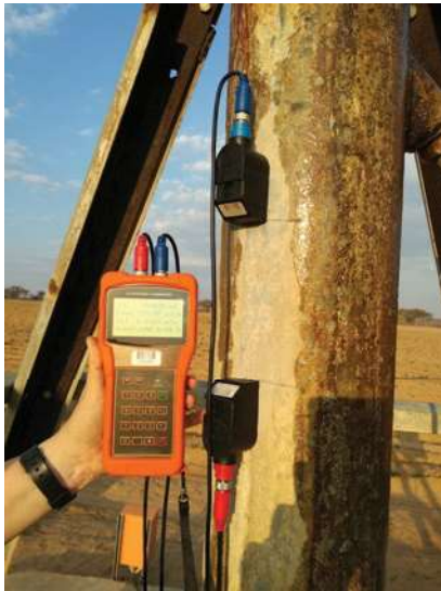
Figuur 1: 'n Aanklamp-vloeimeter is gebruik om spilpunte se vloeitempo te meet.
