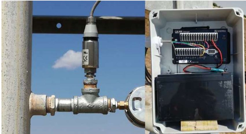
Figuur 2: 'n Elektroniese druksensor (links) en datalogger (regs) is gebruik om besproeiingsure te registreer.
