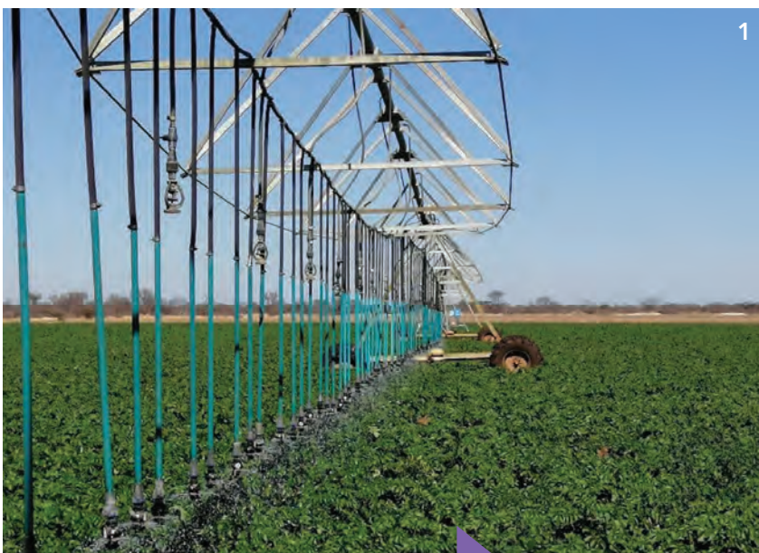
'n Spilpunt wat na 'n LEPA-stelsel omgeskakel is.
