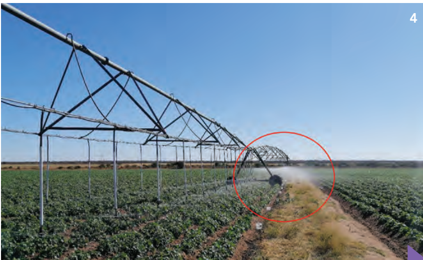
Opbreek van druppels in fyn mis onder die eerste span van LEPA-spilpunt L1. lei tot hoër verdampingsverliese.
