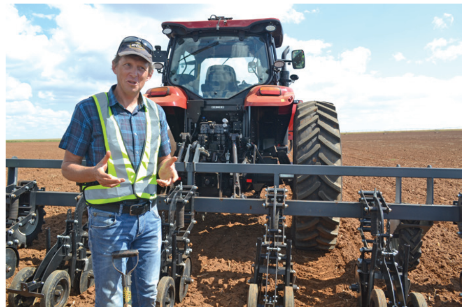
Pieter Hollebrandse, 'n landbou-ingenieur en spesialis aartappelverbouer vir McCain in Suid-Afrika, verduidelik hoe hierdie trekker se wiel-as aangepas is sodat die wiele verder uitmekaar sit. Nou kan dié trekker op dieselfde spoor as die ander masjinerie loop, met die gevolg dat die grondkompaksie nie so erg soos in 'n tradisionele stelsel is nie.
