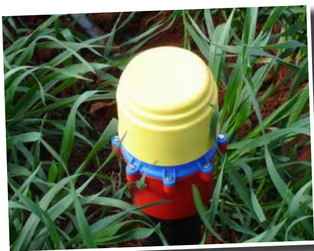
Figuur 4: Kapasitansie-meetinstrument met sensors op verskillende dieptes (bv. elke 10 cm). Die instrument word deur middel van 'n toegangsbuis (regs) in die grondprofiel af laat sak.
