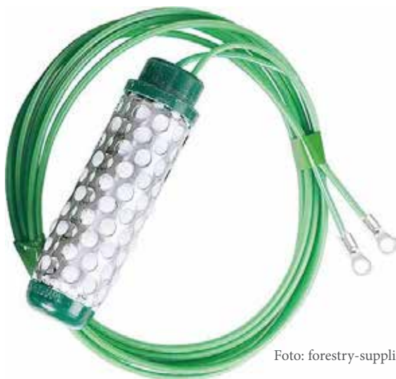
Figuur 2: Watermark elektriese weerstandsensor (links) en digitale meter (regs) vir die meet van grondwaterpotensiaal.
