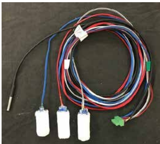
Figuur 3: 'n Stel Chameleon sensors vir die meet van grondtemperatuur en matrikspotensiaal op drie metingsdieptes (links); en LED leser (regs).
