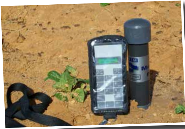
Figuur 5: Voorbeeld van 'n kapasitansie-meetinstrument wat direk in die grond geïnstalleer is. Dit het sensors op vyf verskillende dieptes (elke 10 cm) en data kan met 'n radio-logger (links op die foto) afgelaai word.
