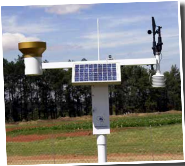
Figuur 3: Voorbeeld van 'n outomatiese weerstasie vir die versameling van heersende weerveranderlikes wat gebruik kan word om atmosferiese verdampingsaanvraag (ETo) te bereken.
