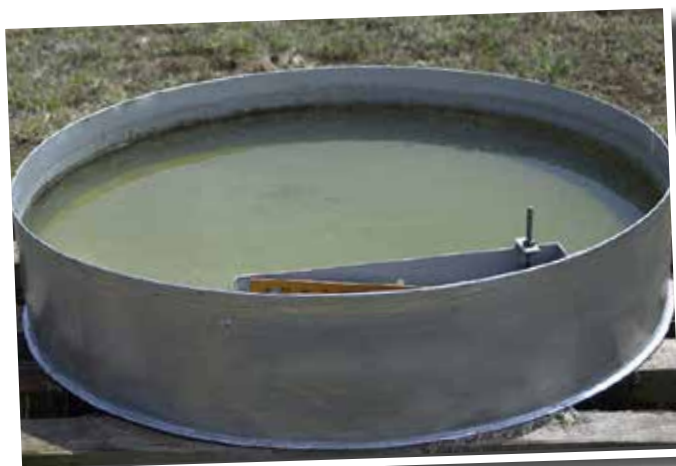
Figuur 1: Klas A panverdamping (Epan) is in die verlede algemeen as maatstaf van atmosferiese verdampingsaanvraag gebruik en tesame met gewasfaktore gebruik om gewaswaterverbruik (ET) te bereken.
