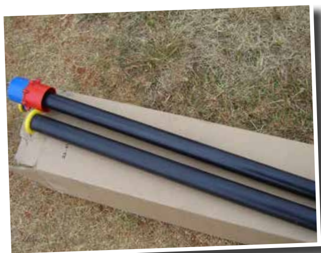
Figuur 4: Kapasitansie-meetinstrument met sensors op verskillende dieptes (bv. elke 10 cm). Die instrument word deur middel van 'n toegangsbuis (regs) in die grondprofiel af laat sak.
