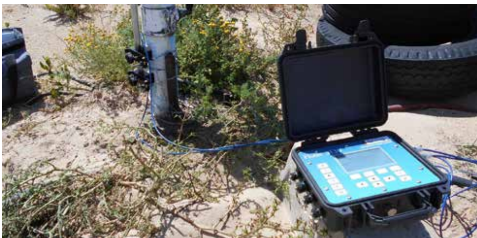
Figuur 6: Gebruik van 'n draagbare vloeiometer om die vloei tempo van 'n spilpunt te bepaal.
