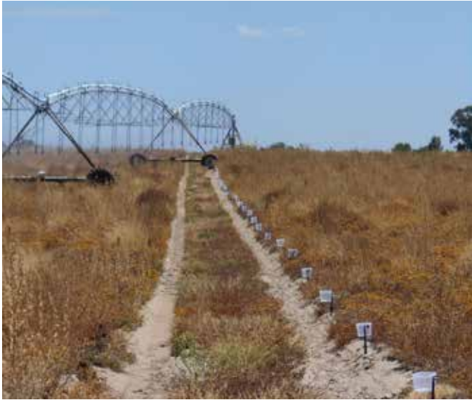
Figuur 7: Verspreidingstoets onder 'n spilpunt deur reënmeteers uit te pak
