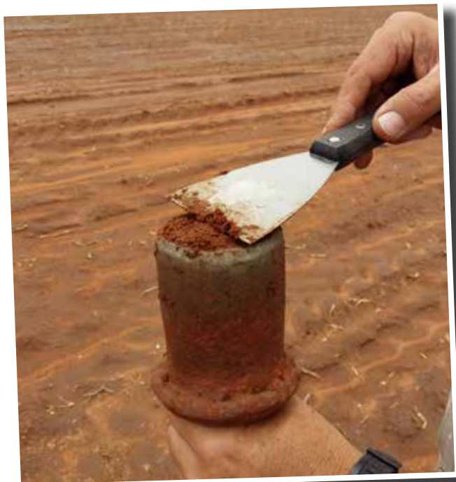
Figuur 1: Monsternemer (“sampler”) met bekende volume vir die neem van grondmonsters.
