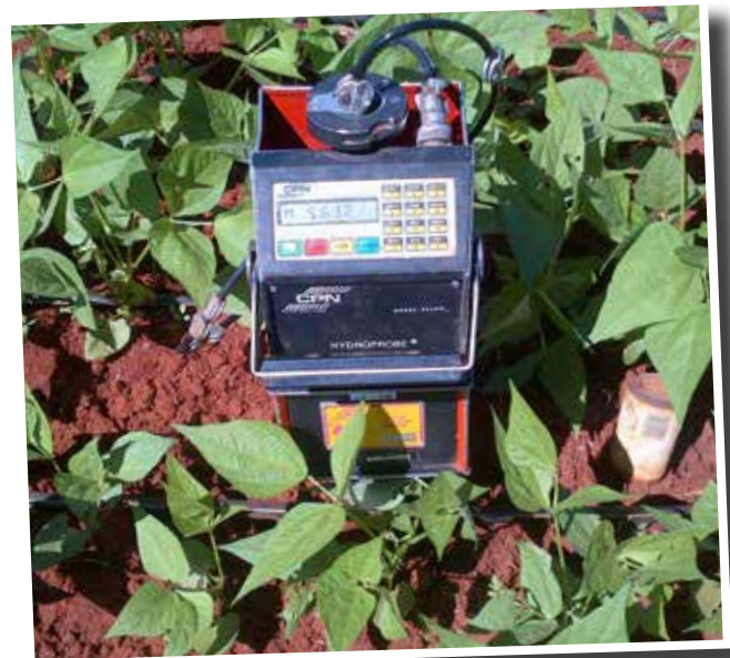
Figuur 2: Die neutronvogneter word op 'n toegangsbuis geplaas en die radioaktiewe bron in die toegangsbuis afgesak om waterinhoud van verskillende grondlae te meet.
