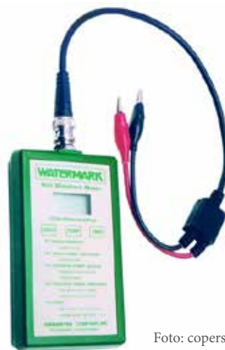
Figuur 2: Watermark elektriese weerstandsensor (links) en digitale meter (regs) vir die meet van grondwaterpotensiaal.
